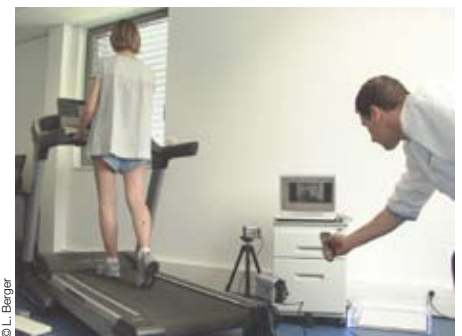
Figure 2. Les sujets marchent sur un tapis roulant à vitesse constante de 3,7 km/h équipés du même modèle de chaussures.
