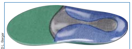
Figure 1. Les orthèses plantaires thermoformées avec renforts latéraux (OR) sont composées d'une base de résine Transflux® (1 mm), renforts latéraux identiques, recouvrement Evamic® (2,5 mm), arrière-pied Orthomic® (3 mm) et avant-pied Viscotène® (2,5 mm).
